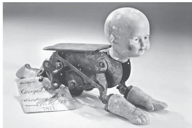
Механический младенец, США. Запатентован Робертом Д. Клеем в 1871 г., усовершенствован Джорджем П. Кларком. Игрушка не пользовалась успехом из-за значительного веса и ненадежности механизма
